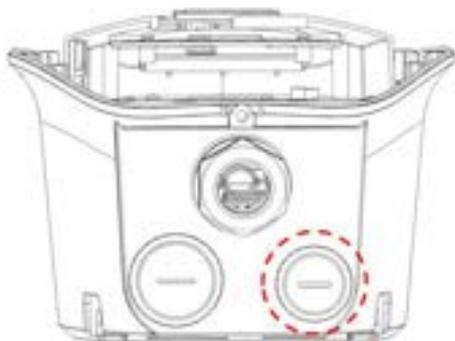
2. Nehmen Sie die wasserfeste Schutzkappe ab und führen Sie das Signalkabel durch die Kabeleinführung. Verwenden Sie eine passende Kabelverschraubung um die Dichtigkeit der Ladesäule sicherzustellen und ein Hineingreifen zu verhindern.
