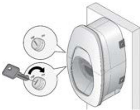
Der Schlüsselschalter befindet sich an der Seite des Produkts. Die Ladestation für Elektrofahrzeuge ist autorisiert, einen Ladevorgang durchzuführen, wenn der Schlüsselschalter auf „On“ (Ein) gestellt ist.
