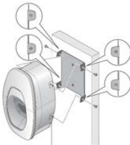
2. Richten Sie die Ladestation an den Schraubenlöchern der Halterung aus.
