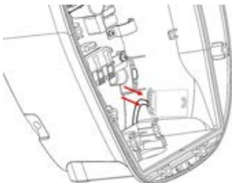
4. Steckverbinder montieren
