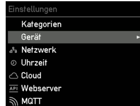
Zur Auswahl des Menüpunktes „Gerät“ die > Taste betätigen. Hier kannst du z. B. die Sprache oder das Display des go-e Controllers an deine Wünsche anpassen.
