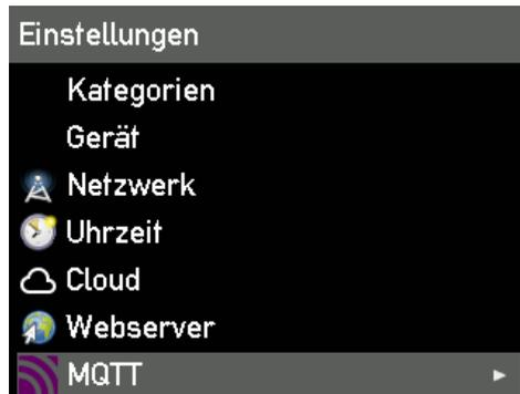
**Für Experten und Integriatoren:** Zur Auswahl des Menüpunktes „MQTT“ die > Taste betätigen.
