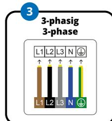
3. Schließe den Controller je nach Stromanschluss ein- oder dreiphasig an. Falls erforderlich, zusätzliche Versorgungsleitung verlegen. Führe die Leiter in die Verbindungsklemme ein und fixiere diese mit einem Schraubendreher. Schließe ebenfalls den Neutralleiter und den Schutzleiter an.
