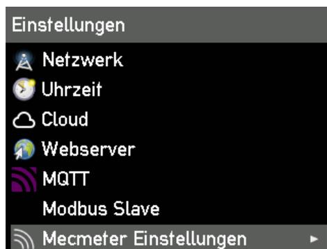
**Für Experten und Integriatoren:** Zur Auswahl des Menüpunktes „MEC Meter“ die > Taste betätigen.
