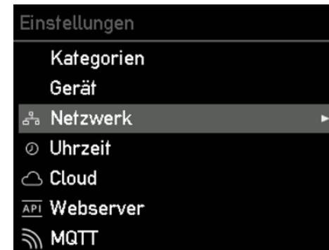
Nun solltest du deinen go-e Controller per WLAN oder LAN in dein Netzwerk bringen. Zur Auswahl des Menüpunktes „Netzwerk“ im Untermenü "Einstellungen" die > Taste betätigen.
