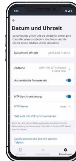
Fortgeschrittene User können hier die Zeitsynchronisierung über einen NTP Server oder die App vornehmen. Wenn der go-e Controller über das Internet mit der go-e Cloud verbunden ist, erhält er durch diese immer die aktuelle Zeit. In diesem Fall sind hier keine Einstellungen erforderlich.
