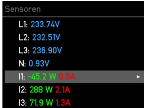
Im Punkt "Sensoren" kannst du die Spannungen, Ströme bzw. Leistungen in Echtzeit ablesen. L1 bis L3 zeigt die Spannung der an der Verbindungsklemme angeschlossenen Phasen. I1 bis I6 zeigt die Werte der angeschlossenen Sensoren (Stromwandler). I entspricht hier der Bezeichnung Internal, was mit dem angeschlossenen Sensor übereinstimmt oder auch Last meint.
