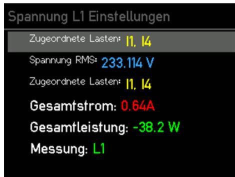
Hier siehst du alle Messwerte der ausgewählten Phase sowie die zugeordneten Lasten (Internals/Staromsensoren). Prüfe einfach, ob die Spannung in etwa stimmt, wenn Strom und Gesamtleistung noch nicht stimmen, ist das kein Problem, denn diese Konfiguration wird etwas später erläutert.
