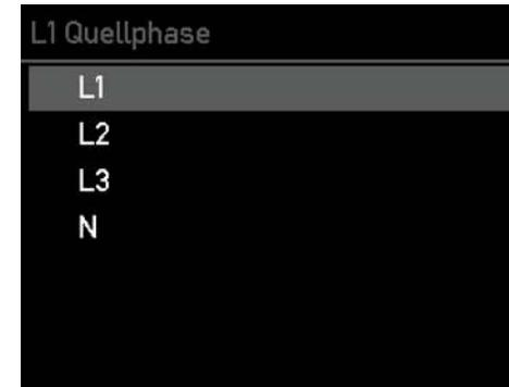
**Optionaler Schritt:** Navigiere mit der Auf- und Ab-Taste zu der Phase, welche du neu zuordnen möchtest, um deine falsch zugeschlossene Phase zu korrigieren.
