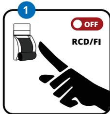
1. Stelle anhand der fünf elektrischen Sicherheitsregeln die Spannungsfreiheit sicher.
