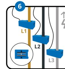
6. Befestige pro Phase einen Stromwandler. Die beiden Pfeile auf dem Stromwandler müssen in Stromrichtung zeigen. Beim Anschluss an das Stromnetz, das wir als "Netz" bezeichnen, sollte der Pfeil vom Stromnetz in Richtung Haus zeigen.\*
