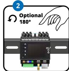
2. go-e Controller auf der DIN-Hutschiene befestigen. Wir empfehlen die Befestigung laut Abbildung. Der Controller kann aber auch um 180° gedreht montiert werden.
