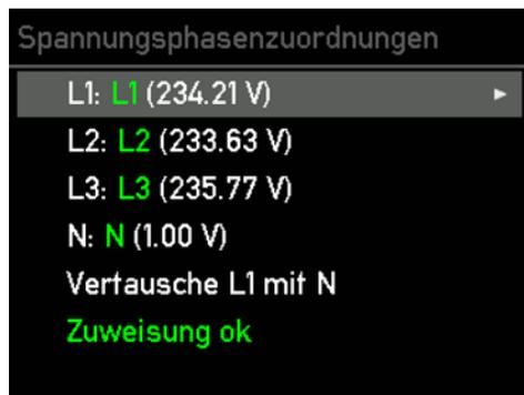
**Optionaler Schritt:** Wähle die Phase, für die du die Zuordnung ändern möchtest, mit der > Taste aus.
