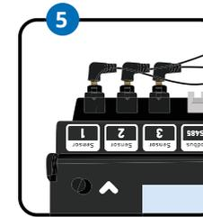
5. Für die PV-Überschussoptimierung benötigen wir genügend Sensoren, um die Leistung vom oder zum Stromnetz zu messen. Bei dreiphasigem Anschluss stecke die Klinkenstecker von drei Stromwandlern in die dafür vorgesehenen Eingänge zur Strommessung. Also z. B. in Sensor eins bis drei. Verwende bei einphasigen Anschluss nur einen Stromwandler. Am einfachsten geht das, wenn wir direkt am Netzanschluss messen.
