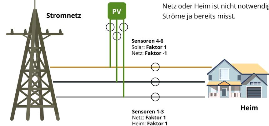
Wir müssen die Solarproduktion von Netz abziehen, daher müssen wir den Faktor auf Minus eins setzen.
