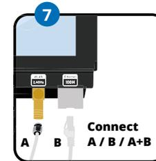
7. Schließe nun die WLAN Antenne und/oder das LAN Kabel am Controller an.
